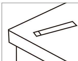
③試験部表面の油を取り除いたら、流水から出して水を払い、平坦な場所に20秒間置きます。
