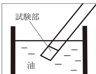
①試験部全面に油脂が付くように浸し、縁で余分な油を素早く除きます。
