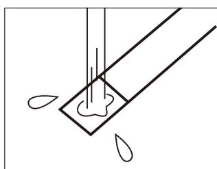
②正確に3分間放置して、純水または水道水の流水で、試験部の油を静かに取り除きます。
