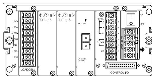
リアパネル：ロードセルや電源類の入力に端子を採用、オプション類もスロット形式（最大2種類同時装着可）で設置やメンテナンス時の作業が簡単です。
