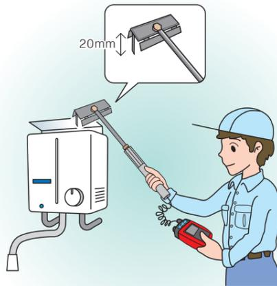
排ガスの採取は、専用のサンプラーを用い、前後左右にゆっくり動かしながらいン上(20mm)をまんべんなくサンプリングします。
