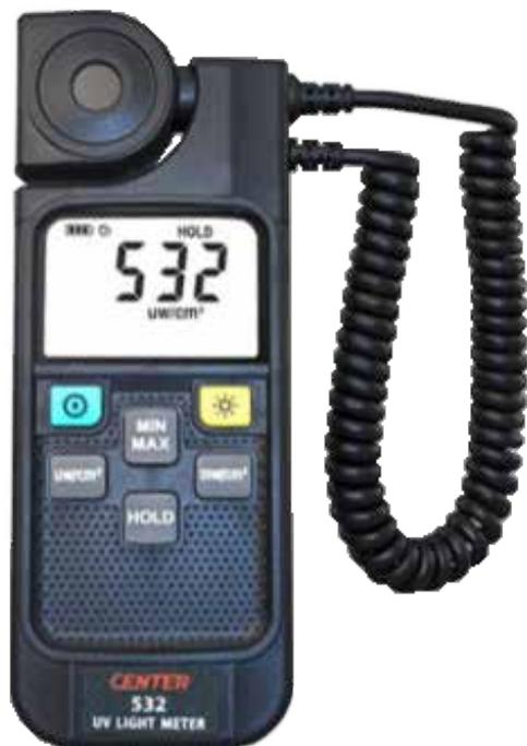
紫外線UVA波およびUVB波の強度を測定するハンディタイプの紫外線強度計
