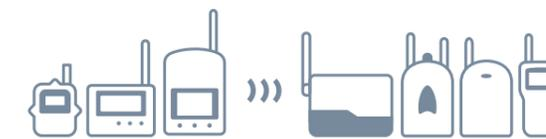
RTR500Bシリーズはデータ収集機(親機)とデータロガー(子機)で構成されています。子機が記録した測定値を、親機が無線で収集し、クラウドやローカルPCに転送します。3種の親機はそれぞれモバイル、LAN、USB通信に対応。子機は温度・湿度の計測をはじめ、電圧・電流・パルスの計測に対応した豊富なラインナップ。大容量電池タイプの子機なら約4年間の長電池寿命です。
