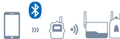
障害物に強く広範囲に届く特定小電力無線通信で、多数の測定ポイントのデータを一気に集められるシリーズです。Bluetooth®にも対応、パソコンを介さずともスマート端末から機器の設定が可能になりました。データは無線で自動収集、安心のHTTPS方式でクラウドサービスへ自動送信。警報監視にも対応し、異常時にはメールで通知します。
