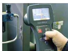
「漏れ検知」 →ターゲットマークが「出現」しています。
