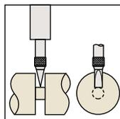
ご注意:超硬ナイフエッジ測定子を使用してステムとの直角度、基準面との平行度及び測定子の方向が必要な場合は、ダイヤルゲージ等を含めた調整が必要となります。特別注文品としてご相談下さい。
