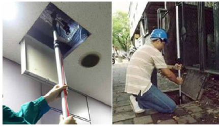
LEDライト付きの伸縮ポールを使えば、天井裏や上下水道の検査にも威力を発揮します。
