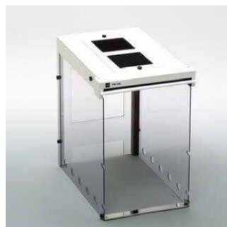
脱臭風防ケース FW-100は、FD-800を内部に設置することができ、高精度天秤が外部から受ける気流による外乱要因を、低減させることができます。また、上部に脱臭フィルタを設けてあり、加熱乾燥時に発生する臭気を軽減させることができます。
