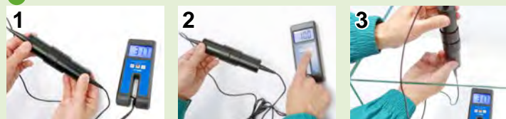
1 センサーを一直線に合わせます 2 CAL ボタンを押し校正します 3 センサーを一直線に合わせて測定します
