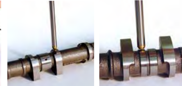
カムシャフトの端面計測例
