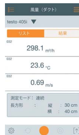
ダクト風量測定 風速・風量・温度を表示 ダクト情報も簡単に設定
