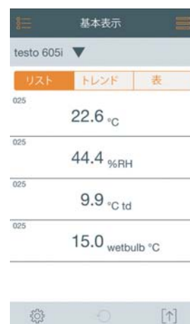
測定値も演算値も同時に表示可能 温度・湿度・露点・湿球温度を表示
