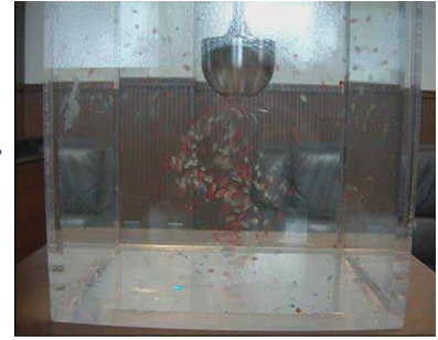
③吸い込まれたビーズが横の吐出口から吐き出される
