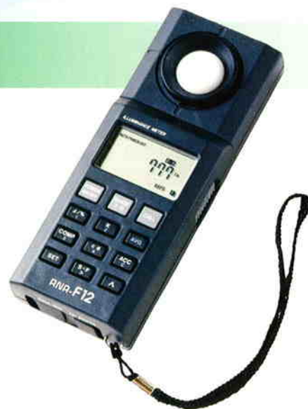
※新JISでは斜入射光に対する照度を等級によりクラス分けし、コサイン法則に照度計の斜入射光特性を近づけています。
