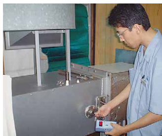
ダクト内測定、風洞実験に
