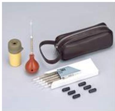
両端を折り取った発煙管に付けたゴム球を圧縮し、空気中の水分に反応して生じた白煙で、気体の流れが確認できます。1本の発煙管で約50回使用できます。
