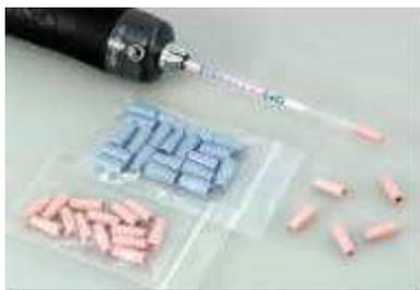
万が一のケガを防止するため、検知管の先端に取り付けるゴム管で、繰り返し使用できます。
