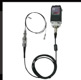
※チャージアンプCA-2012と小型ピックアップVP-02Sの取付イメージ
