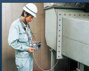
ダクト内の静圧測定に
