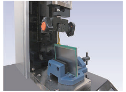
包装容器の突き刺し強度試験
