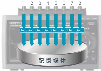
**同時サンプリング方式** サンプリング速度：1μs ~ 1min (1-2-5 ステップ)
