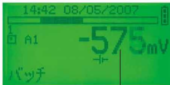
ハーフセル電位測定時
