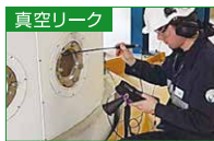
▲ カラーバ－グラフでリアルタイムのRMS(実効値)と最大実効値を表示。 2つの黒線が重なると、四角枠の中に対角線が入り「発生源」を示す。
