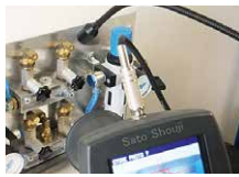
込み入ったところは フレキシブルプローブでチェック (※オプション)。
