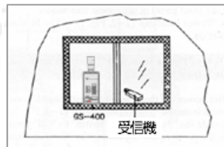
ドアや窓周りの空気漏れ検査
