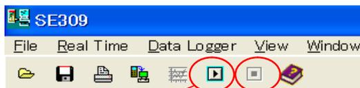
「Run」リアルタイムのデータ収集を開始します。 「Stop」リアルタイムのデータ収集を停止します。
