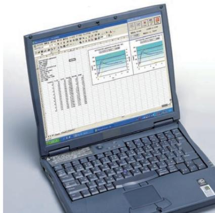
●FD-800はオプションのデータ管理ソフトとMS Excel<sup>®</sup>をインストールしたPCと接続することで、リアルタイムに測定データをPCに転送し、保存することが可能です。また、取り込んだ測定データをグラフ化し視覚的に水分変化や温度状態を確認することができます。グラフは水分および、サーミスタ(T1)温度と放射温度計(T2)温度を表示することができます。
