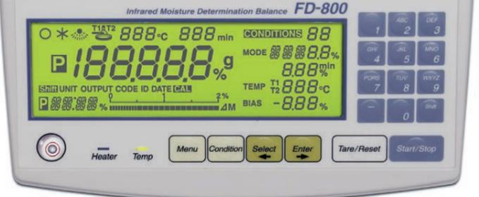
●FD-800の表示部と操作スイッチ。●撮影のためLCDを全表示にしています。実際の使用時とは異なります。
