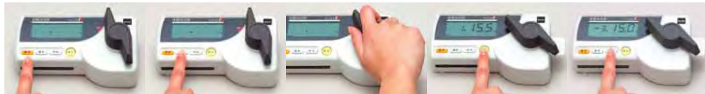
■電源ボタンを押し、「測定待ち」表示にします。■選択ボタンを押し、測定する試料を選びます。■測定部に試料を入れ、一気に粉砕します。■測定ボタンを押すと、水分値を表示します。■平均ボタンで測定回数と平均値を表示します。
