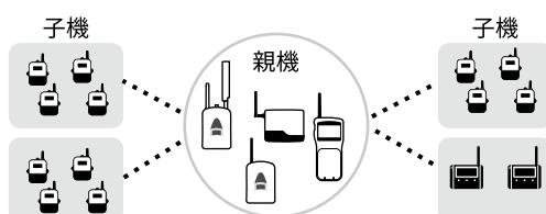
収集したデータは USB、LAN、LTE 通信など多彩な方法で、パソコンや無償クラウドサービス、FTP サーバに取り込めます。また、現在値のモニタリング・異常時の警報メール送信など自動監視も可能で、用途に合わせたデータ管理システムを構築できます。
