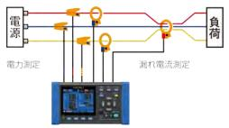
200ms ごとの連続演算処理により、間欠漏電の簡易調査にも 役立ちます。(保存インターバルの項目:平均・最大・最小を選択) 漏れ電流表示
