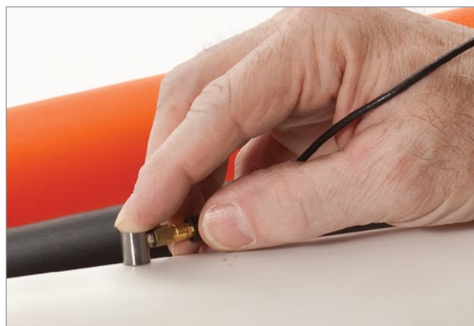
プラスチック、金属、ゴム、ガラス、セラミック、および複合材の肉厚を測定
