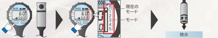
大気中で電源ON 測定箇所にあったモードを選択※ (複数の測定箇所を使い分ける場合) プローブを検水にゆっくり入れ、安定した数値を読み取る
