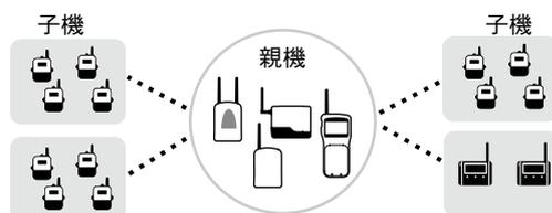
収集したデータは USB、Eメール送信、FTP 送信など多彩な方法でパソコンに取り込めます。また、現在値のモニタリング・異常時の警報メール送信など自動監視も可能で、用途に合わせたデータ管理システムを構築できます。
