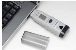
パソコンのUSBポートにロガーを接続します
