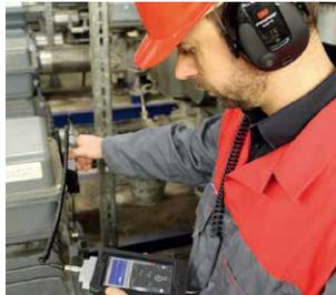
パイプ内のガス、液体、固体の動きや摩擦や漏れにより発生する超音波を検知し、配管からのエア漏れを発見。
