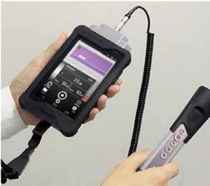
5インチのTFTタッチスクリーンディスプレイ。検知した超音波をスペクトログラムや波形で表示。
