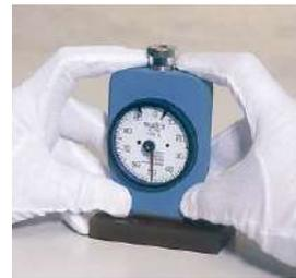
手押しによる硬さ測定は、デュロメータを真上から測定物に押し当て、加圧面を密着させて規格に定められたタイミングで、値を読み取ります。
