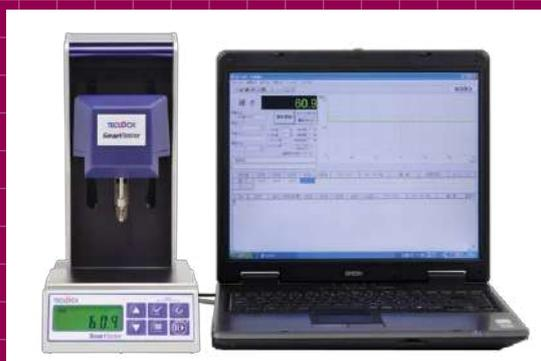
リングや小物ゴム部品、薄いゴムシートなどの硬さを測定するために規定されているのがIRHDマイクロゴム硬さ計です。
