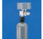
PM2.5サイクロン取付時
