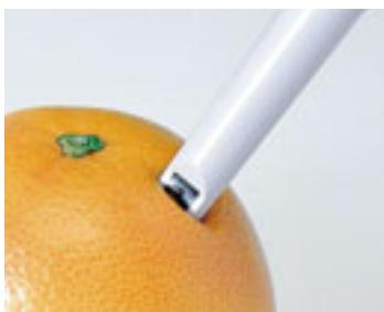
先端を尖らせ、固体への突き刺し測定が可能。
