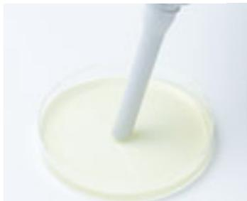
先端平面上にセンサを配置し、応答部段差を  $100\mu\text{m}$  以下に。
