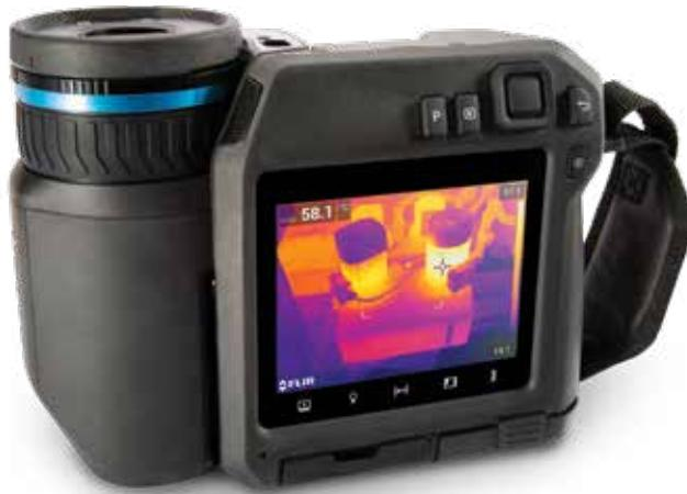
FLIR T560 は、640 × 480 ピクセルの高画素赤外線センサーと人間工学に基づく直観操作を特徴とする赤外線サーモグラフィカメラです。FLIR 独自の輪郭補正技術 MSX を搭載し、鮮明でわかりやすいイメージを得られます。また、180° 回転式のレンズプラットフォームと鮮明な 4 インチの LCD ディスプレイは、どのような撮影アングルにも適応しています。ワンタッチ操作のレベル／スパンやレーザーアシストオートフォーカスといったユーザーの測定をサポートする機能を搭載しています。
