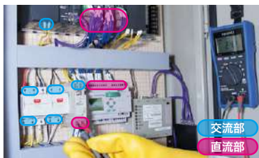
直流、交流電圧が混在する 測定場所で測定を自動で切替
