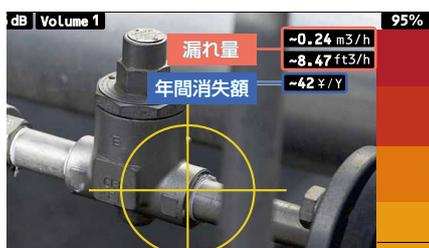
「Kモード」で漏れ箇所の漏れ量(m<sup>3</sup>/h)と
