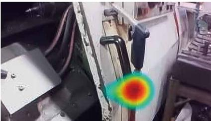
圧縮空気、ガス、真空の漏れを簡単・迅速に検出して見える化。
