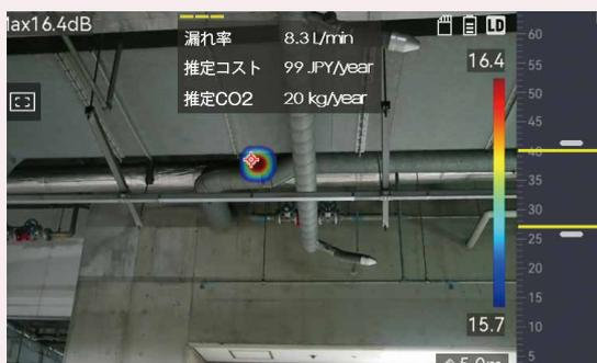
空気漏れの推定漏れ量と損失額、推定 CO<sub>2</sub> を表示
