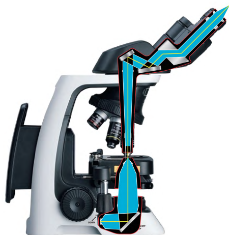
照明範囲が視野に外接するまで、視野絞りダイヤルを回します
