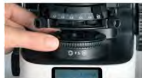
照明範囲が視野に外接するまで、視野絞りダイヤルを回します
