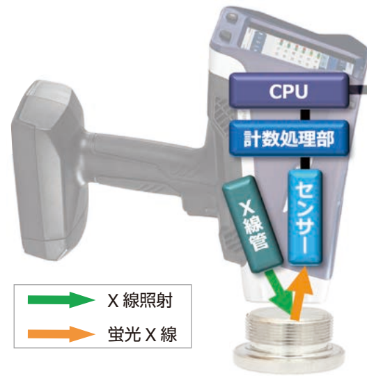
分析時の X 線照射・蛍光 X 線検出イメージ
