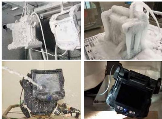
**信頼性と耐久性**は、IP55規格と米国国防軍用規格MIL-STD-810G/461Fに準拠しています。また、1.2mからの落下試験などの衝撃試験にもクリア、耐久性に優れています。さらに、挿入部の耐熱温度(100℃)により、対象物が冷めるのを待たずに検査が開始できます。
