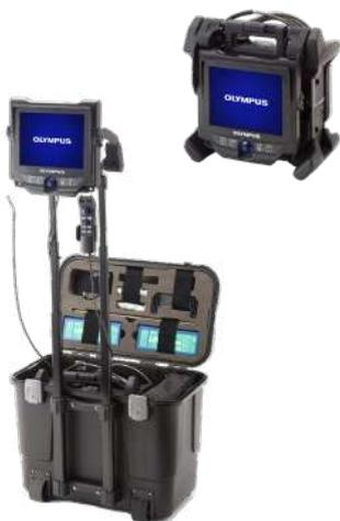
**着脱式スコープユニット**により、さまざまな検査に合わせて適切なスコープを組み合わせできます。
