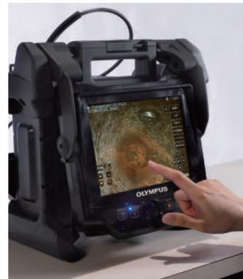
**タッチスクリーン**でメニュー操作をすばやく行えます。また、モニター下部のジョイスティックを操作することにより、スコープの先端湾曲をコントロールすることができます。
