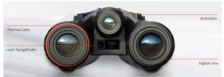
赤外線(IR)照射器：赤外線照射器が内蔵されており、照射角度の調節も可。完全な暗闇でも CMOS センサーによる画像で観察できます。(赤外線波長は 850nm または 940nm から選択可。850nm は最大 400m 先まで照射できますが、光源に赤い可視光が含まれます。940nm は最大 350m 先までの照射距離になりますが、光源に可視光が含まれておらず、撮影に気づかれにくいという利点があります。
