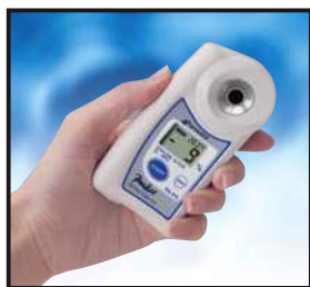
④ STARTキーを2秒以上押し続けると凍結温度を表示します。
