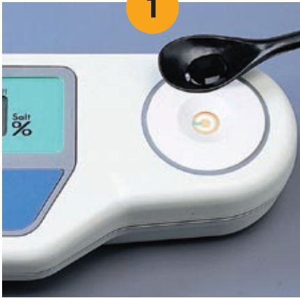
1 サンプルをセンサー部の目やす線より上に満たすように滴下してください。
