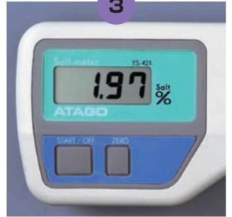
3 矢印が3回点滅した後、サンプルの塩分%を表示します。
